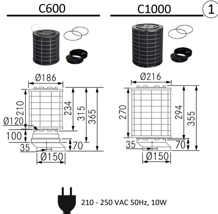
(ES) Instale la campana según proceda en función del modelo seleccionado. Deslice una junta tórica sobre la salida del motor. Si fuera necesario, utilice el adaptador excéntrico para alejar el filtro de la pared o evitar obstáculos, deslice la segunda junta tórica sobre la parte superior del adaptador.
