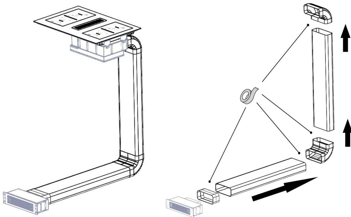
**Conecte los componentes del conducto de aire entre sí e insértelos en la conexión de salida en la parte trasera de la cocina**
