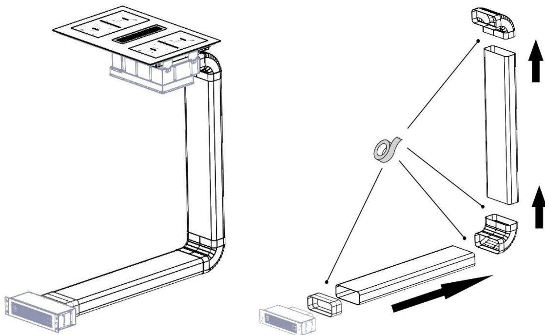
**Connecteu els components del conducte d'aire entre si i inseriu-los a la connexió de sortida a la part posterior de la cuina.**
