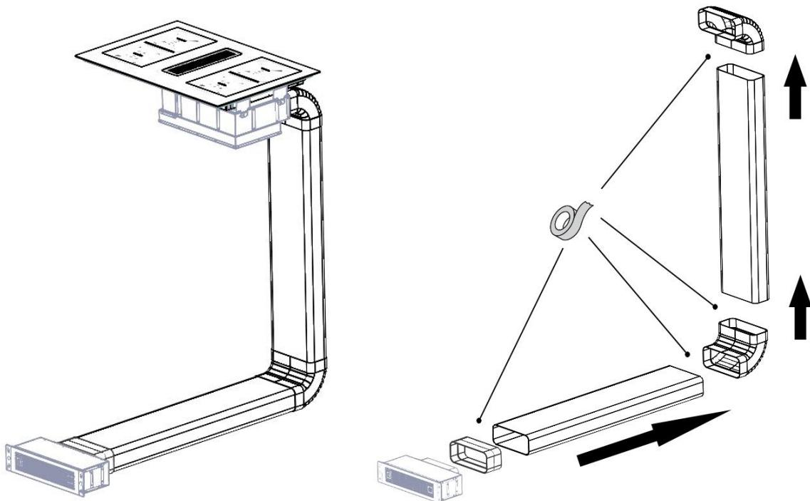
**Verbinden Sie die Komponenten des Luftkanals miteinander und stecken Sie sie in den Auslassanschluss auf der Rückseite des Kochfeldes.**
