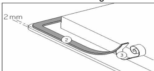
Pegar la junta (2) sobre el reborde de la placa, a 2 mm del borde exterior, después de haber quitado la lámina de protección (3).
