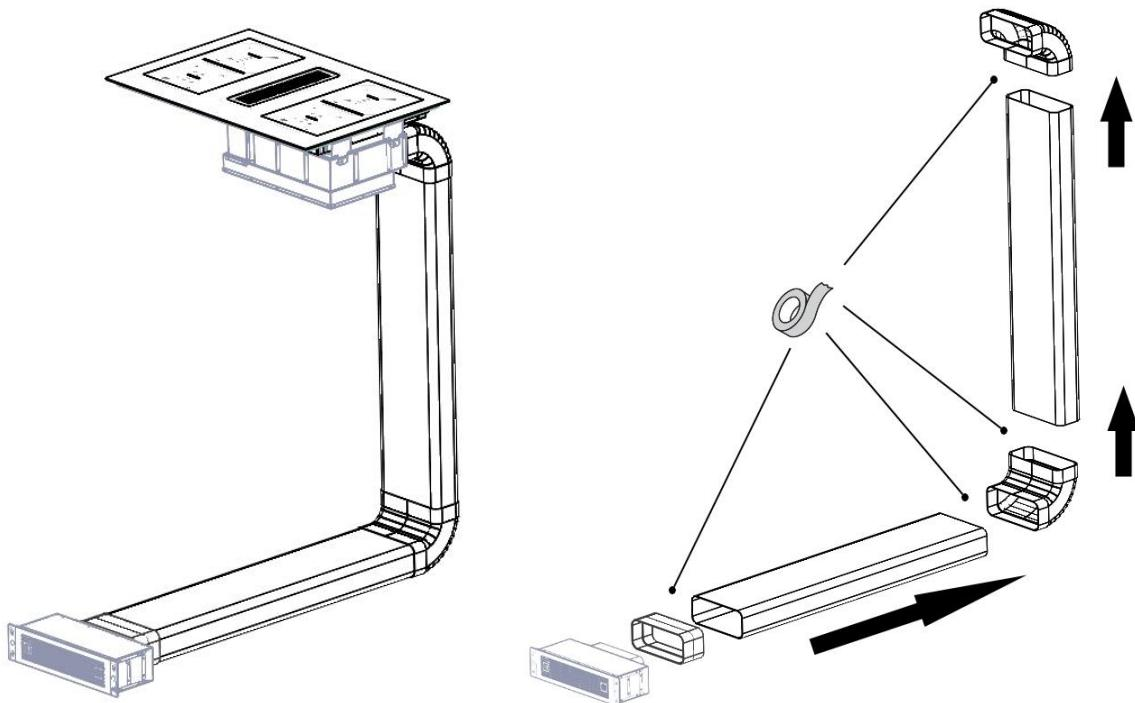
**Raccordez les composants du conduit d'air les uns aux autres et insérez-les sur le raccord de sortie située à l'arrière de la table de cuisson.**
