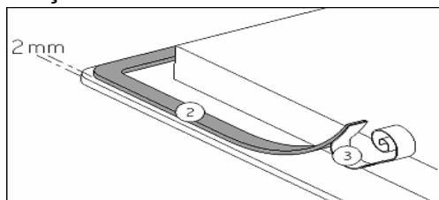
Colar a junta (2) no rebordo da placa, a 2 mm do rebordo exterior, depois de retirar a película (3).
