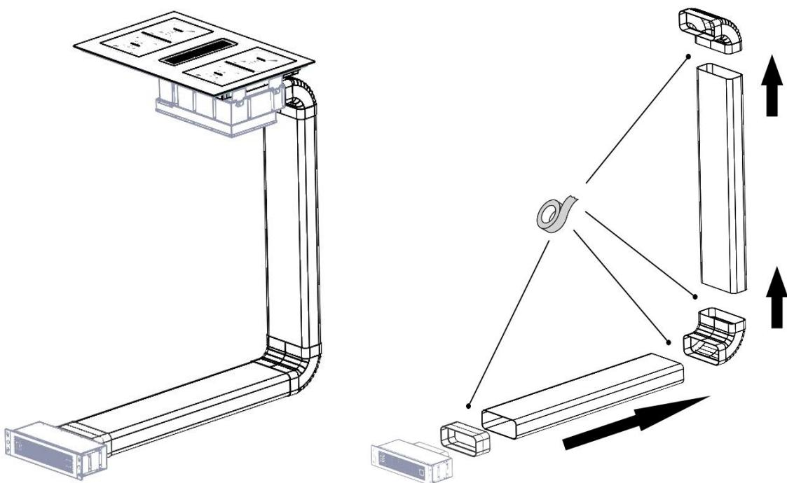
**Ligue os componentes da conduta de ar e inseri-los na ligação de saída na parte de trás da cozinha**
